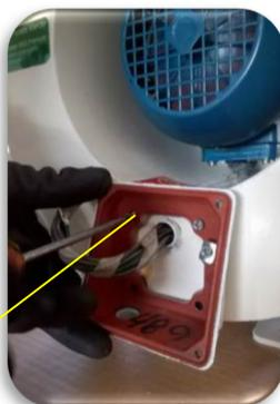
Colocar os parafusos e fixar a base da tampa de ligação do motor.
