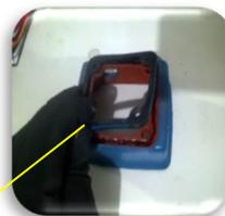
Colocar a borracha com o encaixe no rasgo na base da caixa de ligação do motor.
