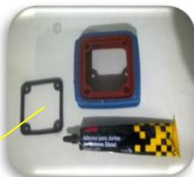
Usa cola 3 M para junta de motores.
