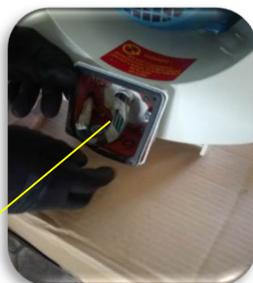
Deixar a borracha plana sobre o rasgo com cola e a base da caixa de ligação do motor.
