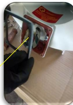
Colar cola em todo perímetro do rasgo onde será colocada a borracha de vedação da tampa da caixa de ligação do motor.
