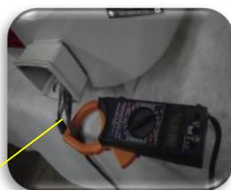
Após o Filtro ser remontado com o rotor, chaveira, refil, parafusos e a panela fechada, faça o teste de corrente. O valor deve ficar dentro da nominal do motor, se ficar a maior ele vai queimar. O sentido de rotação não importa, tem uma chaveira para proteção. O filtro tem o mesmo rendimento não importa o sentido de giro. Não esquecer de ligar o aterramento, na caixa de ligação.
