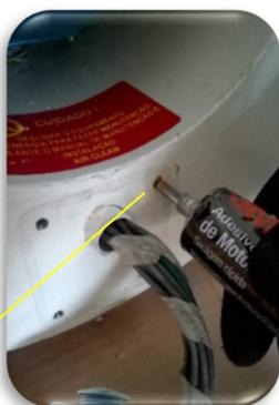
Colocar cola nos quatro furos onde serão colocados os parafusos de fixação da base da caixa de ligação do motor.
