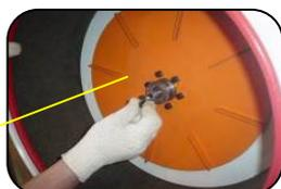
Remover o parafuso M\*x 35 que fixa rotor no eixo do motor. Cuidado para não perder a chaveta e arruela.
