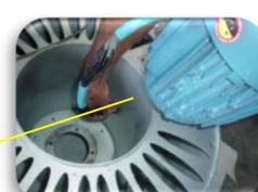
O cabo sendo posicionado na entrada do tubo antes de colocar o motor. Usar um arame pré-enfiado para puxar os cabos ao mesmo tempo em que coloca o motor no flange.
