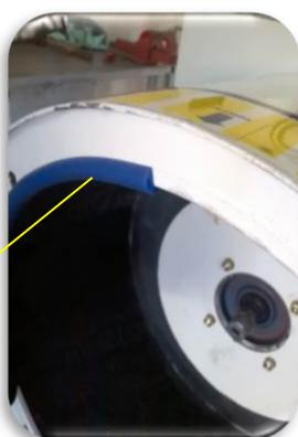
Após colocar cola 3M no rasgo em todo perímetro da borracha, iniciar a montagem na parte superior onde ficará a emenda.
