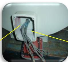
Os 4 parafusos que fixam a caixa de ligação à carcaça, deve ter cola 3M em suas roscas. Assim evitaremos vazamentos de óleo para dentro da caixa elétrica.
