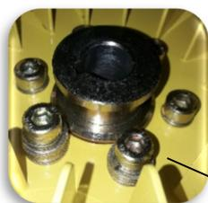
Pode ocorrer que alguns parafusos estão sem arruelas e outros com arruelas (1, 2 ... esta é a forma de balancear atualmente). Pode ser feita na bancada utilizando um equipamento de análise de vibração. Este tipo de balanceamento é ideal por balancear o rotor no local de utilização.
