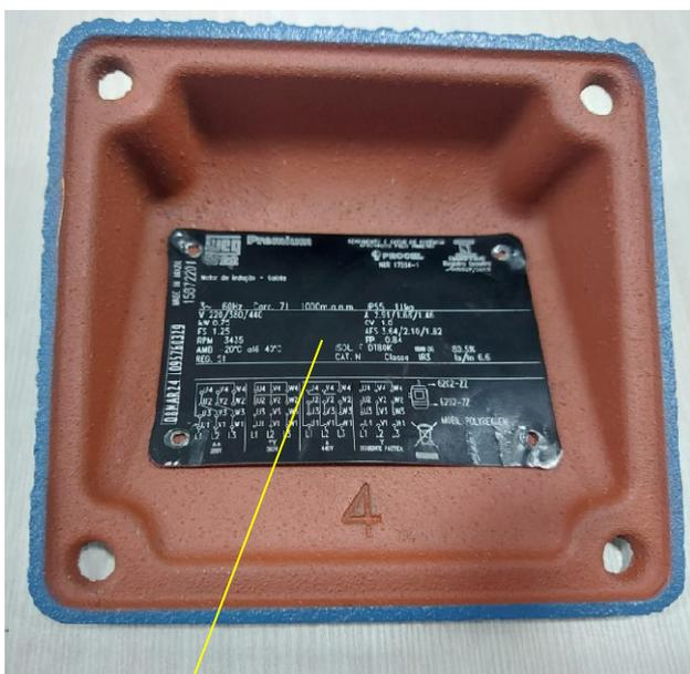
Placa original do motor que é retirado e colocado aqui para facilitar a sua visualização.
