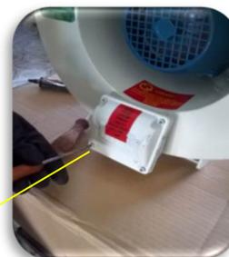
Colocar os parafusos e fixar a tampa na caixa de ligação do motor. Nestes parafusos não é necessário colocar cola
