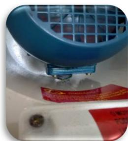
Neste ponto onde os cabos saem do motor e entram no tubo que leva à caixa de ligação, não é necessário fazer nada. O próprio tubo é mais elevado que a chapa em torno de 10 mm, evitando que o óleo entre no tubo. Se entrar, não irá chegar à caixa de ligação do motor, porque o procedimento ao lado foi feito.
