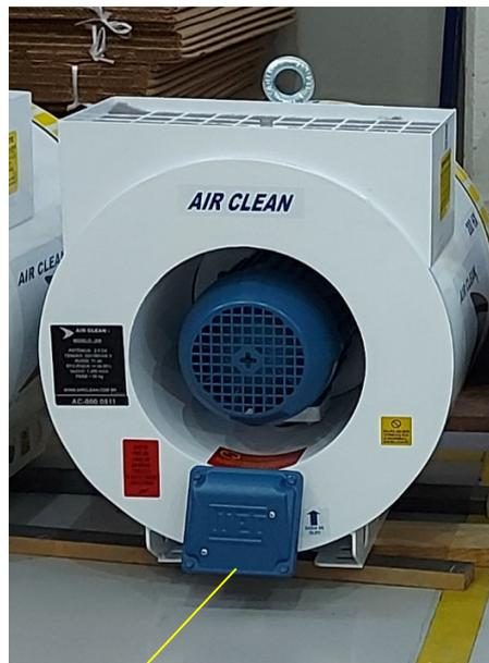
Dentro desta caixa original do motor, está a placa com o número de série e dados do motor utilizado.
