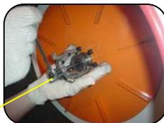
Usando extrator remover o rotor. Não retirar os 6 parafusos do rotor, eles fazem parte do balanceamento.
