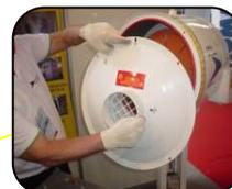
Remover os 8 parafusos M8x25 da Panela
