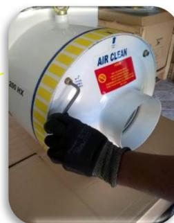
Após colocar a cola em todos os furos, colocar a tampa frontal e os parafusos. Um leve aperto é suficiente, senão a tampa frontal irá entortar e pode vaziar.
