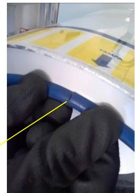
Forçar para que as duas partes se juntem e que fiquem bem pressionadas uma contra a outra.
