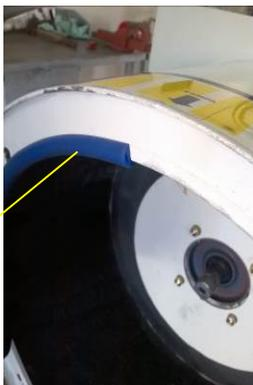
Após colocar cola 3M no rasgo em todo perímetro da borracha, aguarde 5 minutos antes de iniciar a montagem na parte superior onde ficará a emenda.
